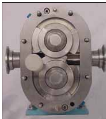
Abbildung 9 - unteren Rotor lösen
