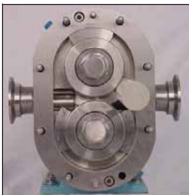
Abbildung 8 - oberen Rotor lösen
